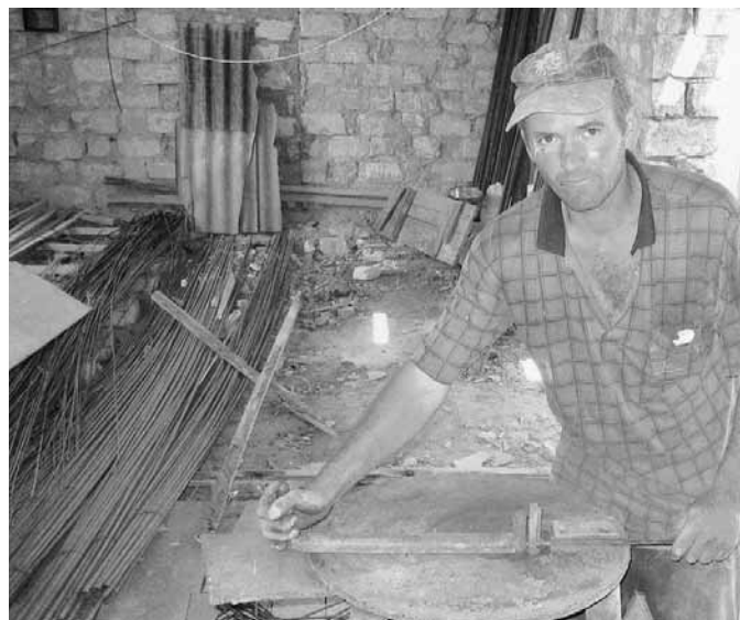
■ Einfache Herstellung der Armierungsglieder durch einen Arbeiter. Links im seitlichen Hintergrund Baustahlvorrat. Bilder: Hartig
